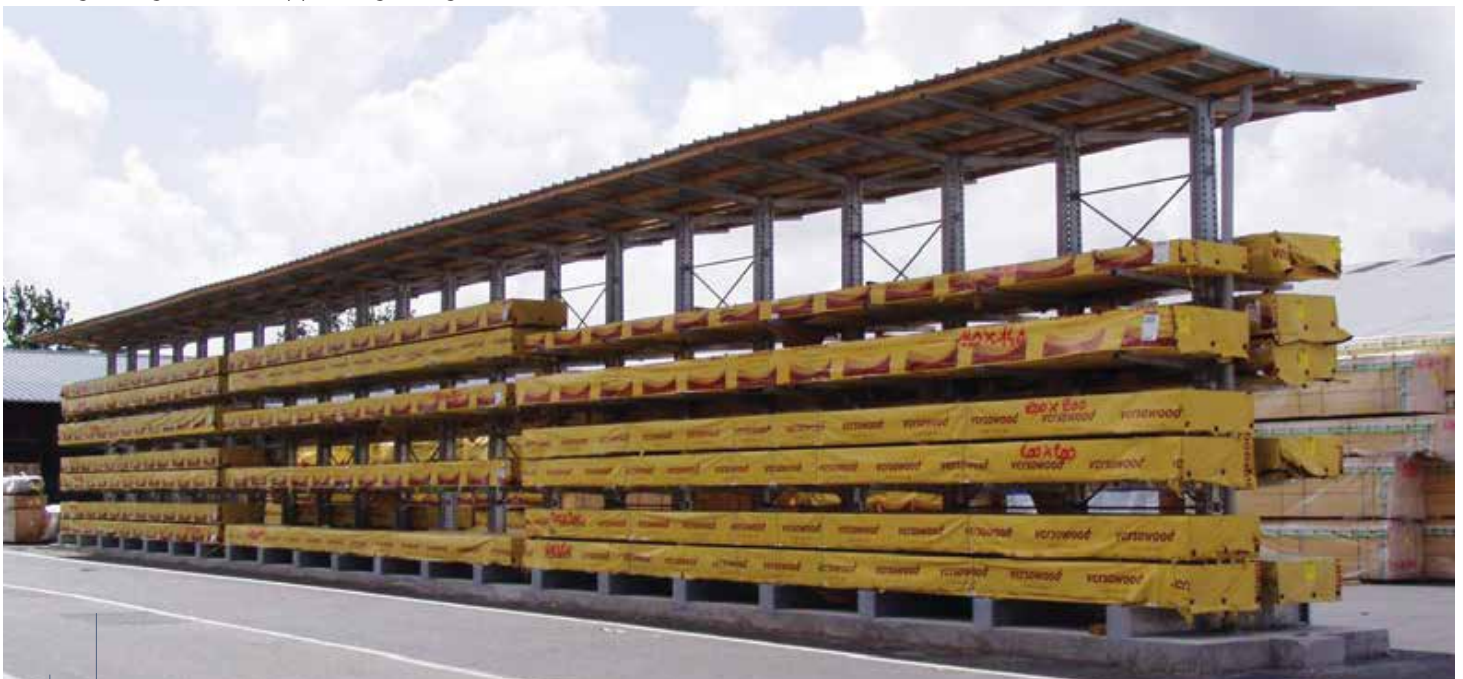
Außenlagerung von langen Lasten mit Schutzdächern
